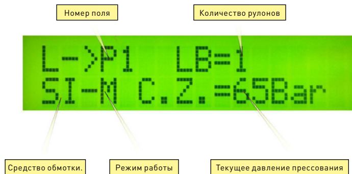
Рис. 18. Главный экран панели управления.
