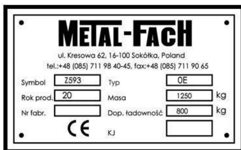
Рис. 1 Данные, указанные на заводском щитке.
