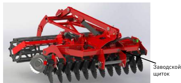
Рис. 2. Место крепления заводского щитка на машине
