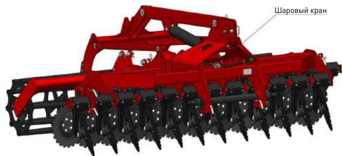
Рис. 11. Способ блокировки культиватора в транспортном положении.
