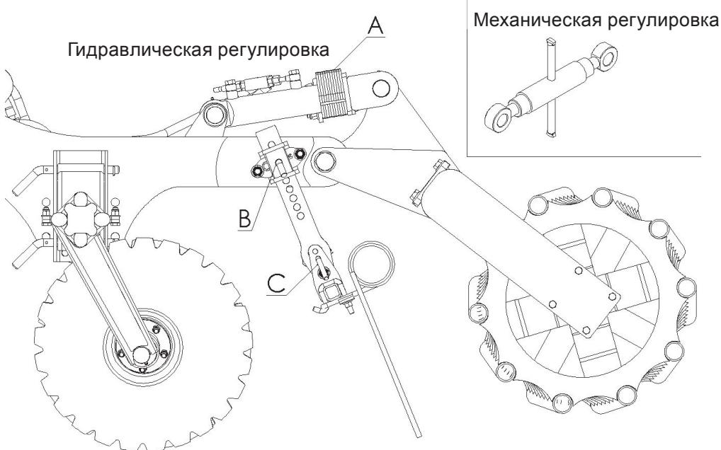
Рис.5. Регулировка работы культиватора.
