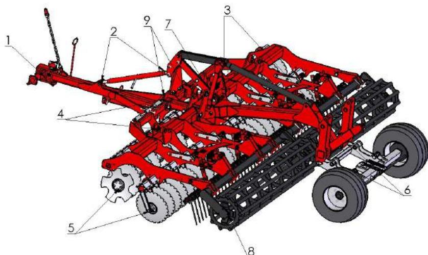
**Рис. 6.** 1 – втулка шарнира, 2 – винты шпинделя сцепки, 3 – винты шпинделя шасси, 4, 6 – гидроцилиндры (проушина цилиндра), 5 – подшипниковый узел дискового держателя, 7 – шарнир шасси, 8 – подшипниковый узел вала, 9 – шквони плеч.
