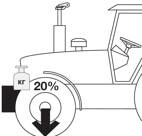
**Рис.7. Минимальная нагрузка на переднюю ось трактора**
