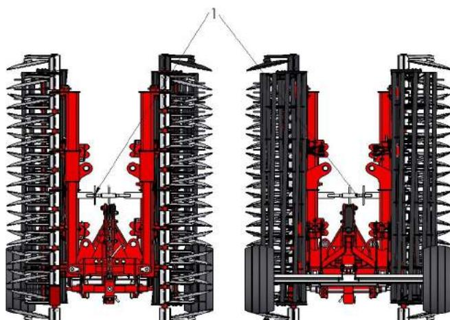
**Рис. 1 Транспортировочное положение культиватора - 1 - соединительная тяга.**
