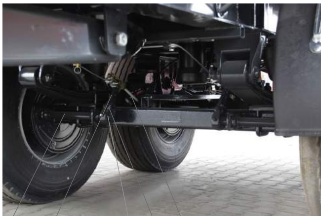
Рис. 6. Элементы тормозной системы 1 – вал тормозного кулака, 2 – рычаг (плечо) вала тормозного кулака, 3 – зубчатка и регулирующий винт на вале тормозного кулака, 4 – тяга (толкатель), соединяющая поршень пневмоцилиндра с плечом вала тормозного кулака, 5 – винт регулировки.
