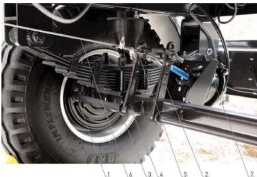
Рис. 6. Элементы тормозной системы:
